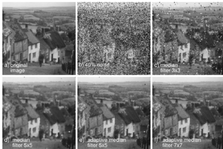
Obrázek 2.7: Ukázka aplikace mediánového a adaptivního mediánového filtru na obrázek ze 40 % zašuměný šumem sůl a pepř. Byly využity různé velikosti okolí posuvného okna. Zdroj: [10].
