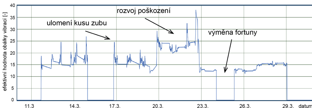
Obrázek 26 Ulomení zubu pastorkového kola fortuny a její výměna [41].
