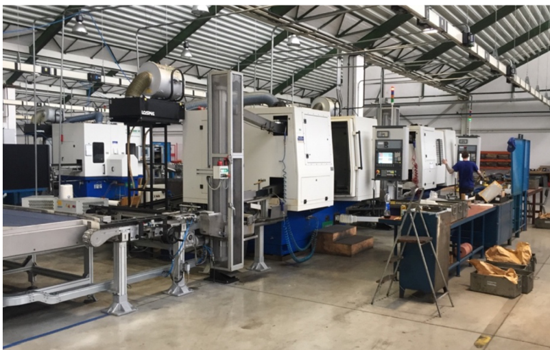
Obrázek 14 Linka O.ERRE.PI na opracování oběžných drah vnějších kroužků valivých ložisek. MTI 250 DRD (blíže na obrázku) a MTI 250 CUP (dále na obrázku).
