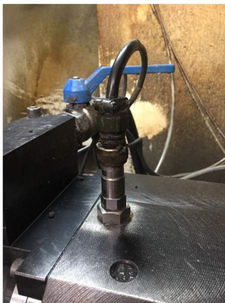
Obrázek 22 Senzor vibrací měřící vibrace vřetene a fortuny.
