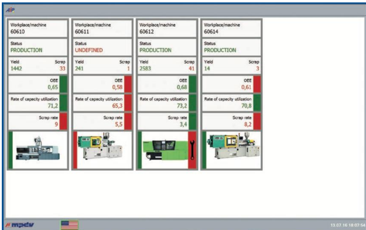
Obrázek 3.7 – Upozornění na zastavený stroj v MES systému Hydra [16].
