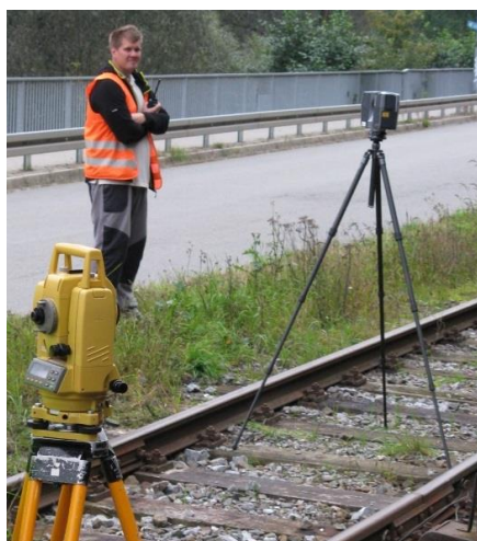
Obr. 9.3. Pozice totální stanice a skeneru
