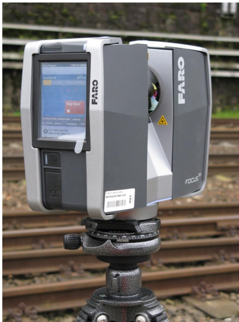
Obr. 5.2. Pozemní skener FARO FOCUS 3D
