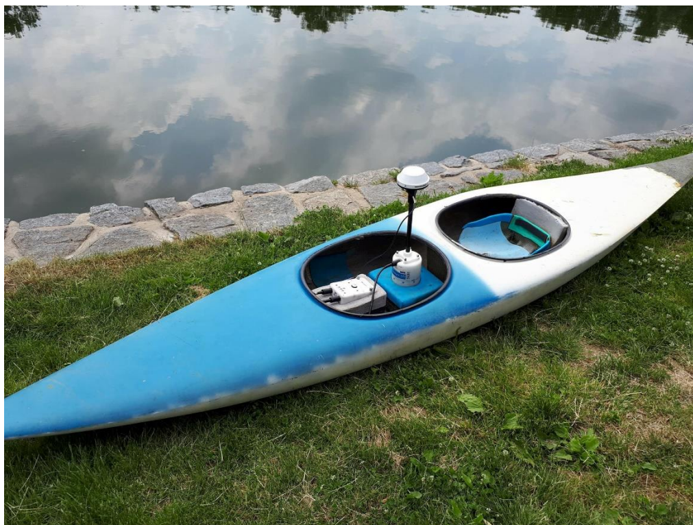
Obr. č. 6: Připevnění měřicí aparatury RiverSurveyor M9 na kajaku (Autor, 2018)
