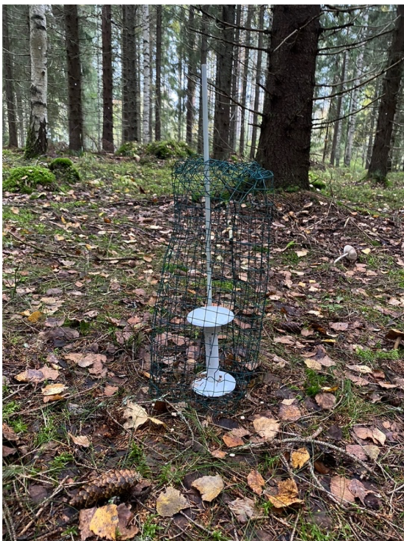
Obrázek 6. Půdní čidlo TMS4 s ochranným pletivem proti poškození zvěří umístěné na výzkumné ploše.
