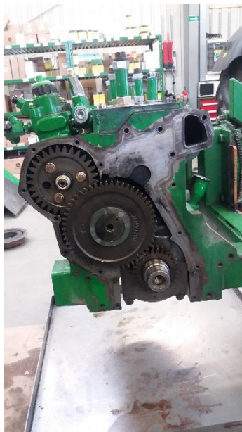
Obrázek 4.12: Montáž ozubeného kola vysokotlakého vstříkovacího čerpadla
