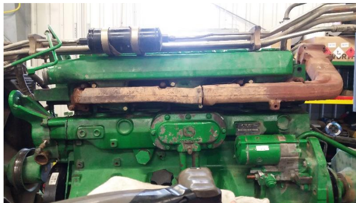
Obrázek 4.23: Montáž sacího a výfukového potrubí
