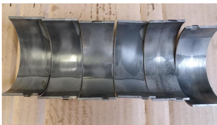
Obrázek 4.4: Poškozená pouzdra z ojníc
