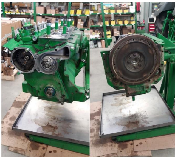
Obrázek 4.13: Vlevo montáž vodního čerpadla, vpravo montáž setrvačnicku
