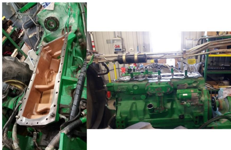
Obrázek 4.15: Vlevo olejová vana motoru, vpravo usazený motor zpět na traktor
