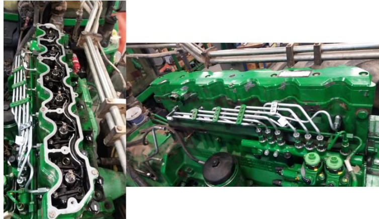
Obrázek 4.22: Vlevo montáž svodové kabeláže vstříkovače, vpravo montáž krytu vahadel
