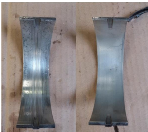
Obrázek 4.3: Poškozená pouzdra klikové hřídele, vlevo na 3. válci, vpravo na 4. válci
