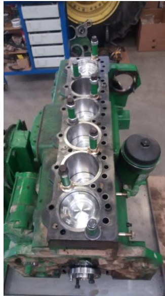
Obrázek 4.8: Uchycení vložených válců pomocí šroubů s podložkami
