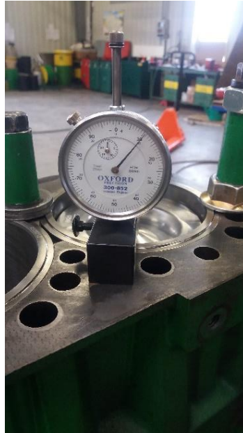
Obrázek 4.10: Měření přesahů pomocí číselníkového odchytkoměru
