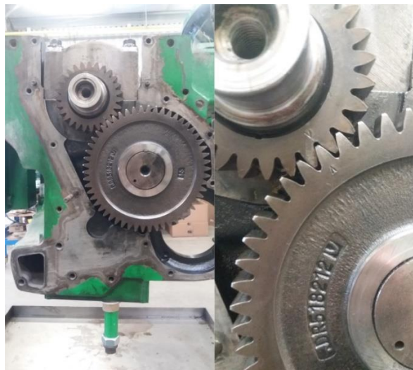
Obrázek 4.11: Seřízení klikové hřídele a vačkové hřídele
