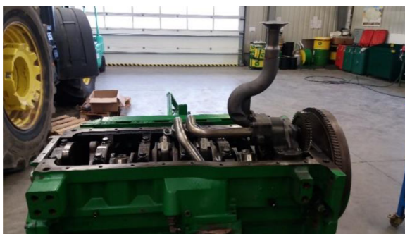
Obrázek 4.14: Montáž olejového čerpadla motoru
