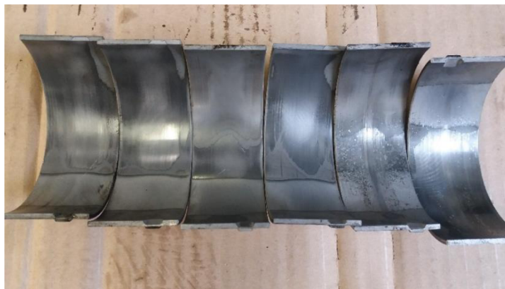
Obrázek 4.4: Poškozená pouzdra z ojníc
