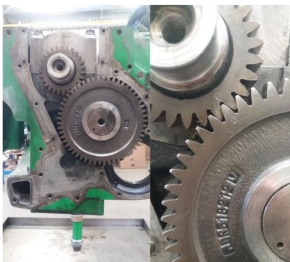
Obrázek 4.11: Seřízení klikové hřídele a vačkové hřídele
