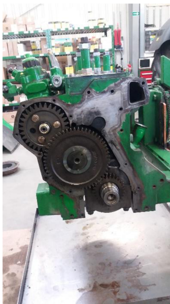
Obrázek 4.12: Montáž ozubeného kola vysokotlakého vstřikovacího čerpadla
