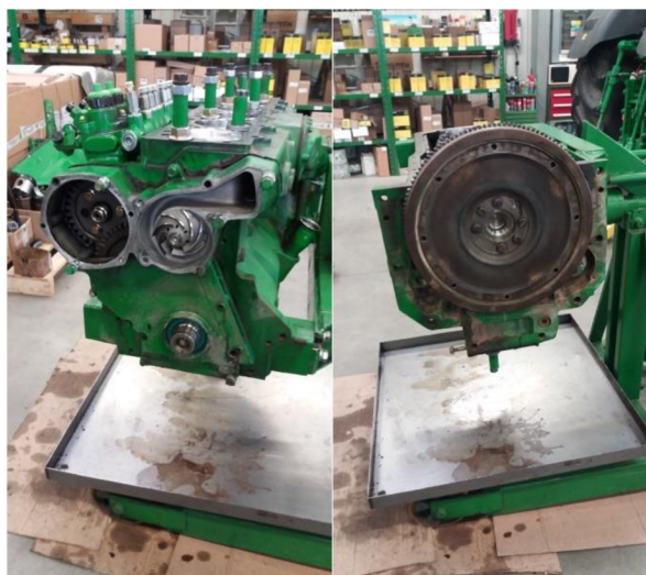
Obrázek 4.13: Vlevo montáž vodního čerpadla, vpravo montáž setrvačnicku
