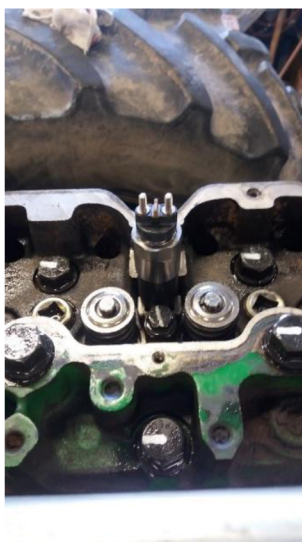
Obrázek 4.18: Montáž vstříkovače do hlavy válců
