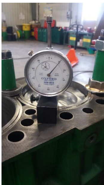
Obrázek 4.10: Měření přesahů pomocí číselníkového odchylkoměru
