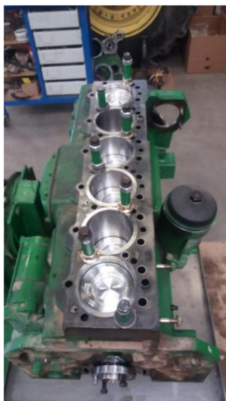
Obrázek 4.8: Uchycení vložených válců pomocí šroubů s podložkami
