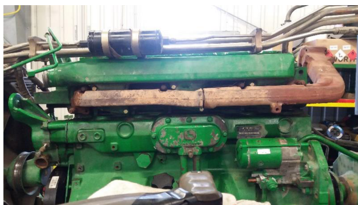
Obrázek 4.23: Montáž sacího a výfukového potrubí
