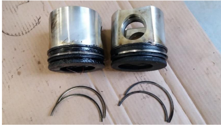
Obrázek 4.1: Poškozené pístní kroužky, vlevo na 4. válci, vpravo na 3. válci
