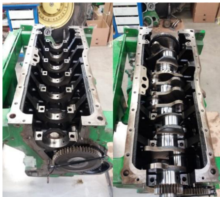
Obrázek 4.6: Montáž klikového hřídele
