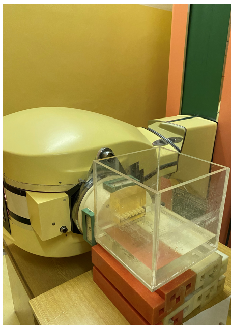
Obrázek 3.4: Ve vodním fantomu umístěném těsně k primárním clonám ozařovače Chisostat jsou ponořené zkoumané vzorky k ozáření [autor].
