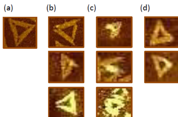
Obrázek 3.8: Čtyři druhy DNA origami. Zleva nepoškozené, poškozené, denaturované a deformované [autor].
