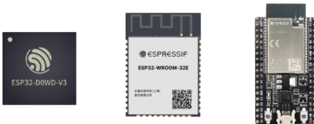
Obrázek 4.1: Varianty distribuce Espressif čipů. Zprava — samostatný SoC ESP32-D0W0-V3 , modul ESP32-WROOM-32 s integrovanou PCB anténou, vývojová deska ESP32 DevKitC s modulem ESP32-WROVER a USB rozhraním. Použité obrázky jsou převzaty z webové prezentace Espressif Systems [10].
