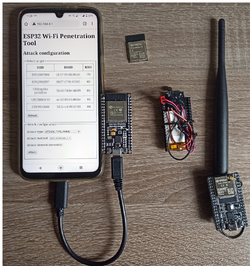
Obrázek B.1: Na obrázku jsou zachyceny různé varianty zapojení a použití ESP32 s nástrojem ESP32 Wi-Fi Penetration Tool. Zleva je vývojová deska ESP32 napájená z chytrého telefonu pomocí OTG funkce a zároveň je zde zachyceno uživatelské prostředí na mobilním telefonu. Uprostřed se nachází vývojová deska ESP32-DEVKITC-32E připojená k Li-Pol baterii. Vpravo je zachycena vývojová deska ESP32-DEVKITC-32UE s připojenou externí anténou pomocí I-PEX konektoru. Pro porovnání velikosti je uprostřed nahoře přiložen i samostatný modul ESP32-WROOM-32E.
