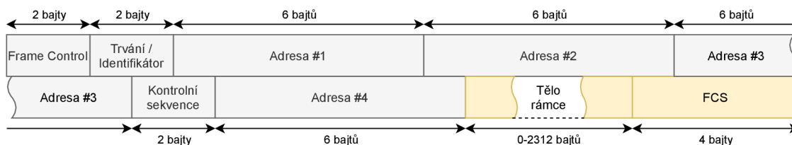
Obrázek 2.4: Obecný formát rámce. Šedé podbarvení značí prvky, jež jsou součástí MAC hlavičky.
