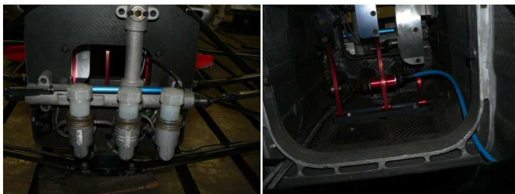
Obr. 3.14: Hlavní brzdové válce a pedálová skupina formule Renault
