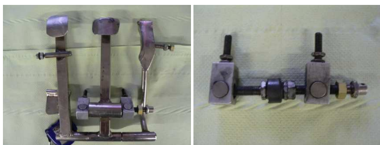
Obr. 3.12: Pedálová skupina a vahadlo se závitovou tyčí a převodnými kostkami
