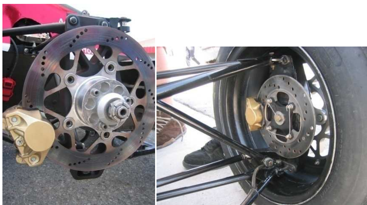
Obr. 3.8: Ukázka umístění kotouče před a za těhlicí [8]
