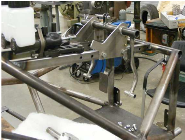
Obr. 3.1: Závěsné uchycení pedálu [8]
