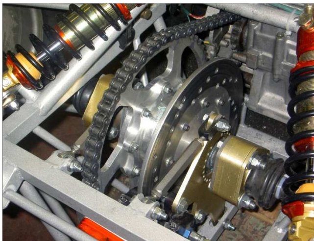
Obr. 3.10: Ukázka brzdy přímo spojené s diferenciálem [8]
