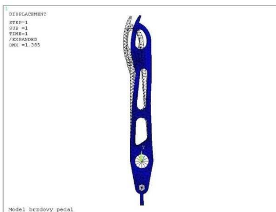
Obr. 3.55: Deformace pedálu v měřítku
