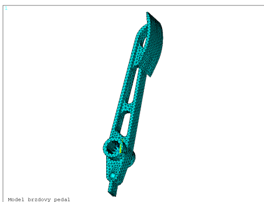
Obr. 3.52: Vysítovaný celý objem součásti
