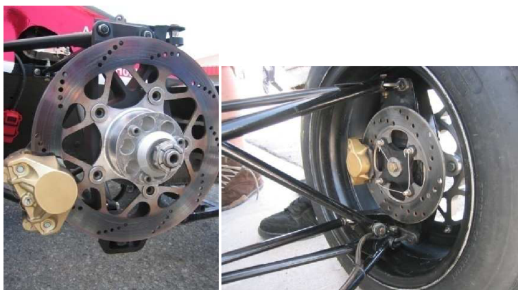
Obr. 3.8: Ukázka umístění kotouče před a za těhlicí [8]
