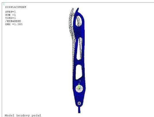
Obr. 3.55: Deformace pedálu v měřítku
