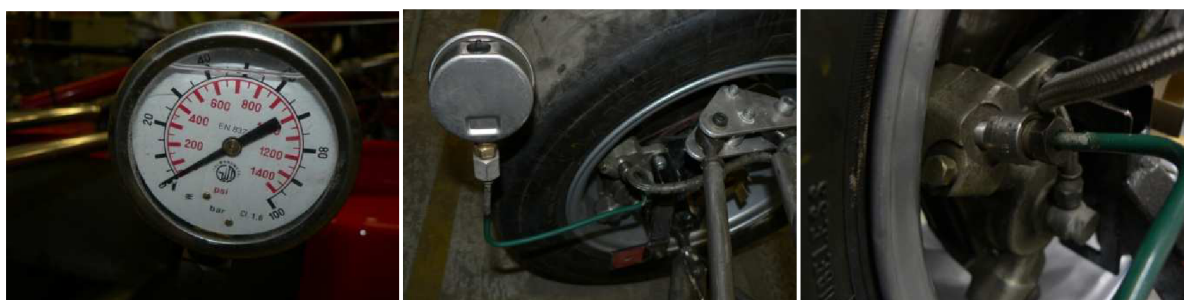
Obr. 3.13: Měření tlaku v systému: manometr, umístění manometru a detail připojení
