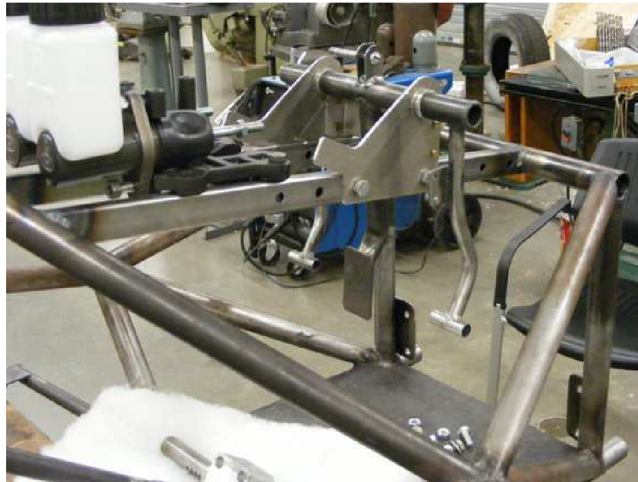
Obr. 3.1: Závěsné uchycení pedálu [8]
