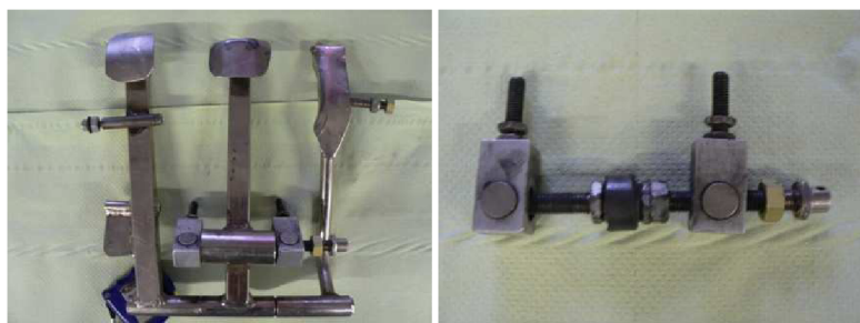
Obr. 3.12: Pedálová skupina a vahadlo se závitovou tyčí a převodnými kostkami
