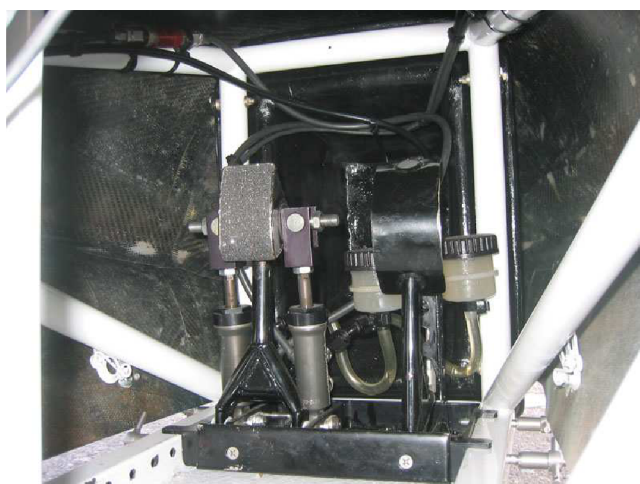
Obr. 3.3: Kompaktní sestava se stojatými pedály a vertikálně umístěnými hl. brzd. válci [8]
