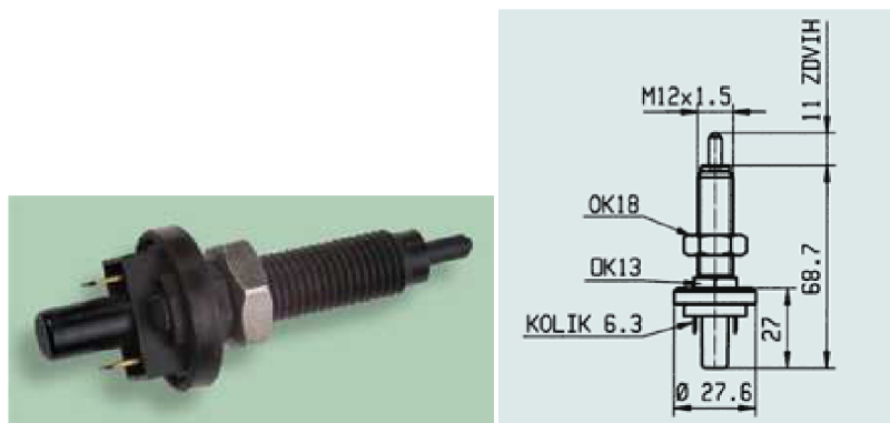
Obr. 3.26: Brzdový spínač a jeho schéma [13]
