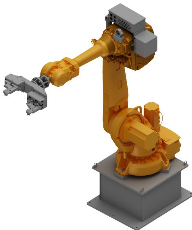
Obr. 76 Robot IRB 4600 s uchopovacím zařízením (vizualizace Inventor 2019)
