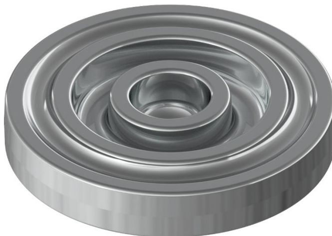
Obr. 61 Vizualizace výkovku bez výronku
