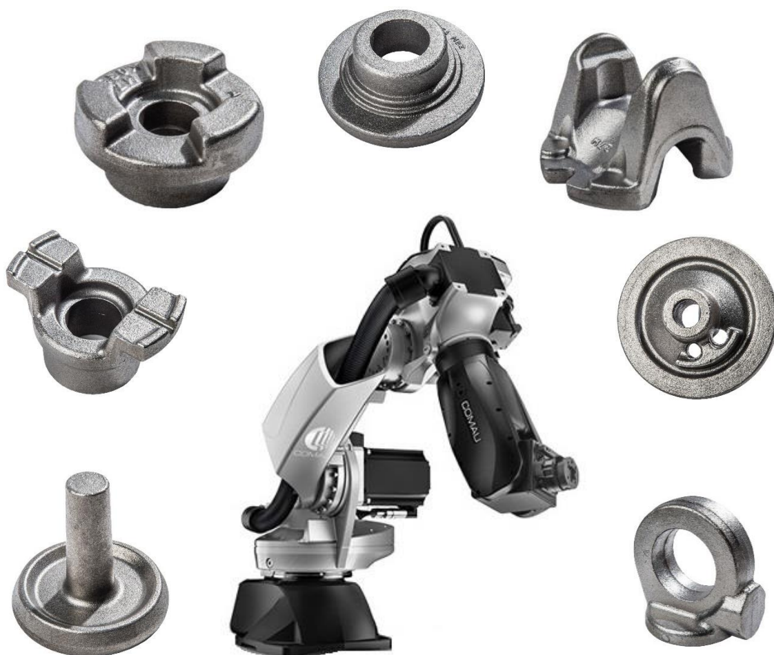
Obr. 1 Příklady výkovků a šestiosého kloubového robota [4], [5]
