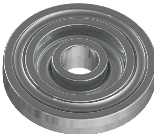
Obr. 62 Vizualizace ostříženého a děrovaného výkovku
