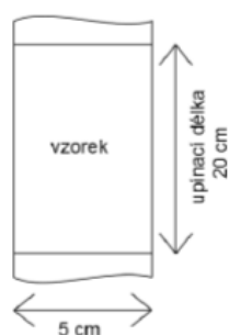
Obr. 9: Tvar vzorku pleteniny pro zkoušku pevnosti v tahu a tažnosti [3]
