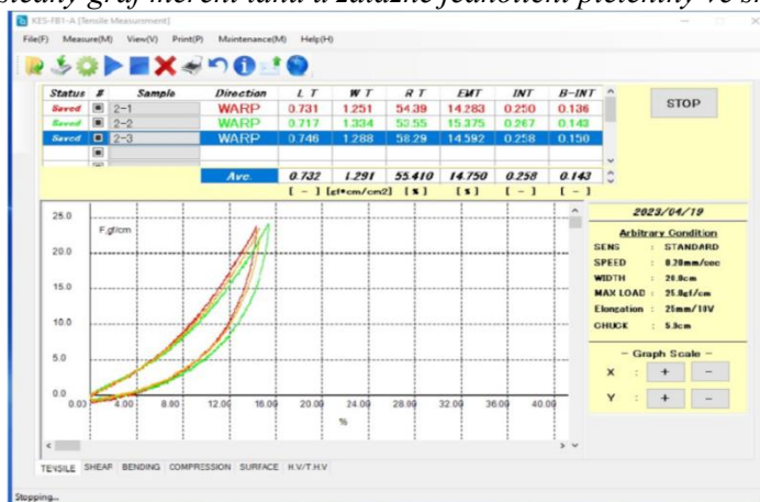
Obr. 17: Výsledný graf měření tahu u zátazné oboucílní pleteniny ve směru sloupku.
