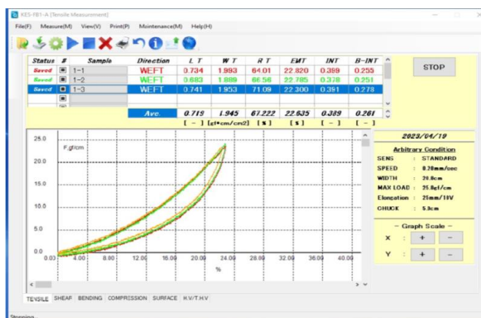
Obr. 15: Výsledný graf měření tahu u zátazné jedolící pleteniny ve směru řádku.
