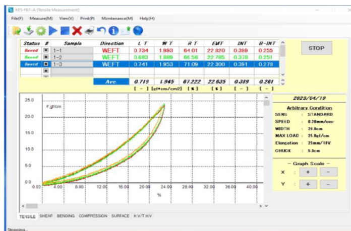
Obr. 15: Výsledný graf měření tahu u zátazné jedolnicní pleteniny ve směru řádku.
