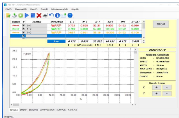
Obr. 16: Výsledný graf měření tahu u zátazné jednocílní pleteniny ve směru sloupku.
