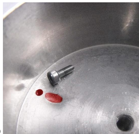
Obr. 4-39 a) Upínací svěrka, náhrada kolíků; b) drážka pro vyjmutí vzorku a závitová díra
