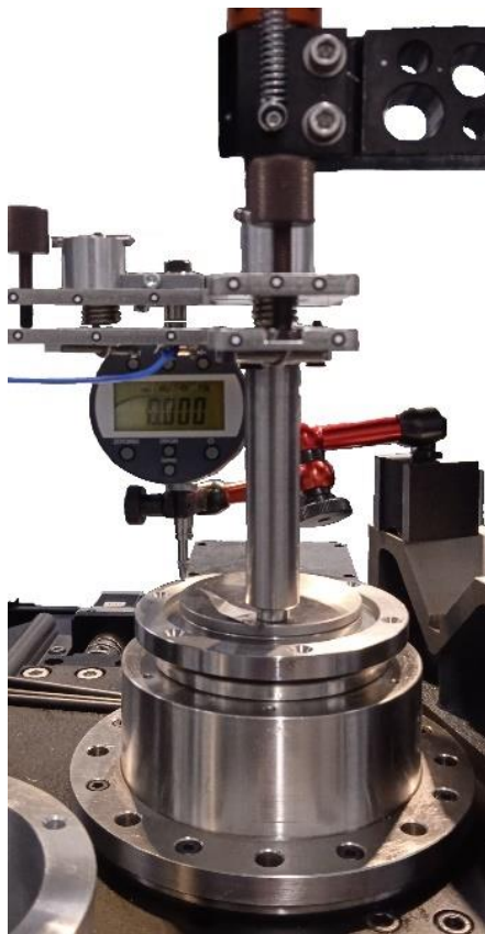
Obr. 4-42 Vyrovnání stojanu modulu
