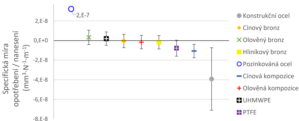
Obr. 6-2 Míra změny hmotnosti pinů (nanášení a úbytek materiálu)
