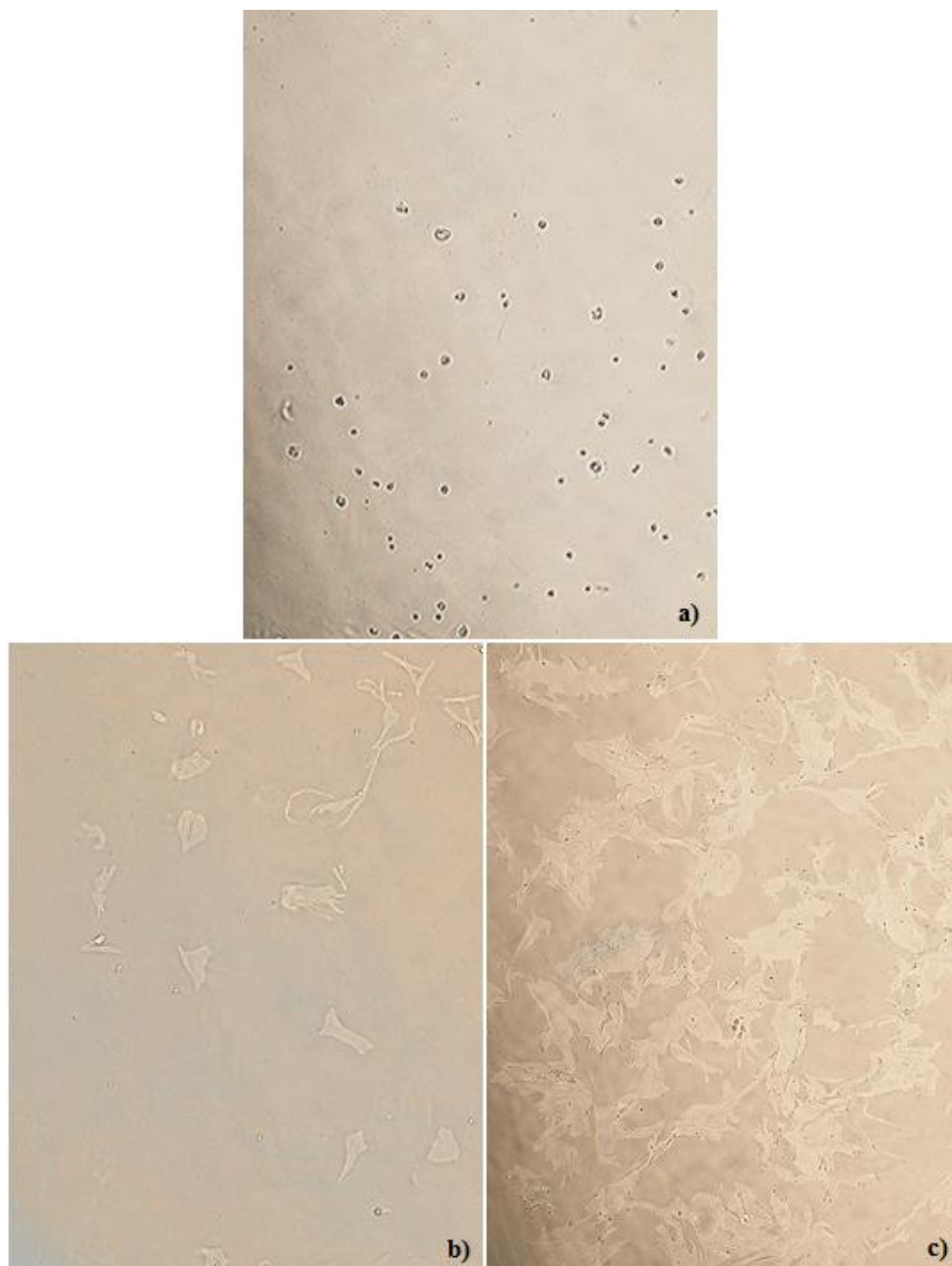
Obrázek 22: (a) substrát s vrstvou, která byla připravena při 60 °C a 100 sccm; (b) kontrolní substrát bez vrstvy; (c) kontrolní vzorek v okolí substrátu.
