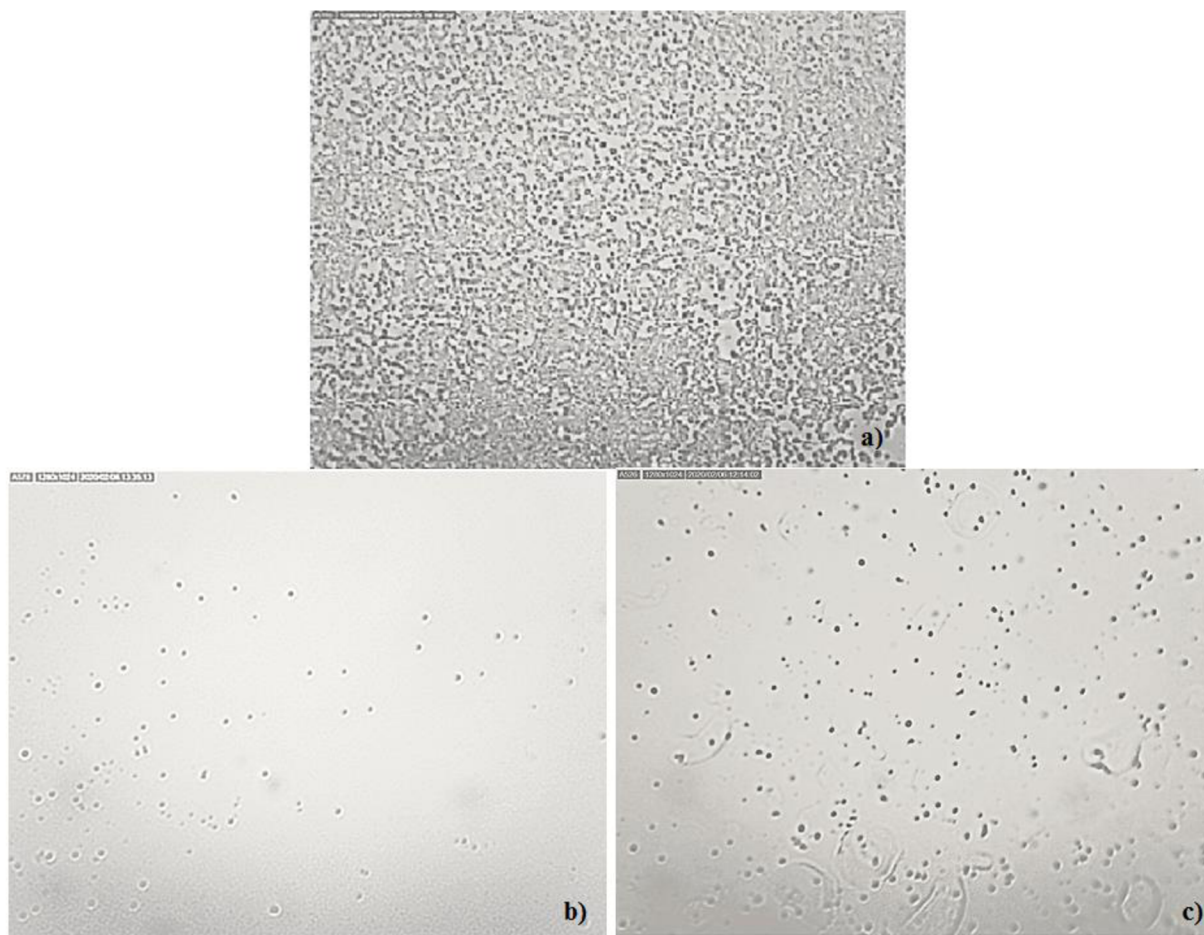
Obrázek 26: Snímky filmů uložených na substrátu s bakteriemi S. epidermidis (a) substrát bez vrstvy [7]; (b) 20 °C; (c) 60 sccm.
