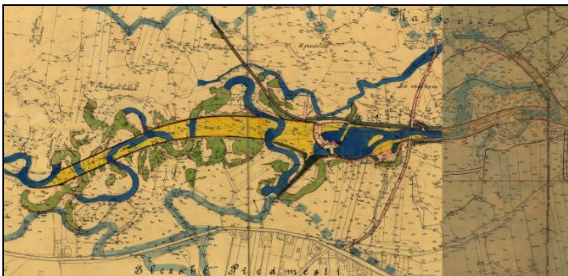
Obr. 1 Návrh úpravy Orlice nad Malšovickým jezem (1923), dle skutečného provedení. Zdroj: Povodí Labe, státní podnik
