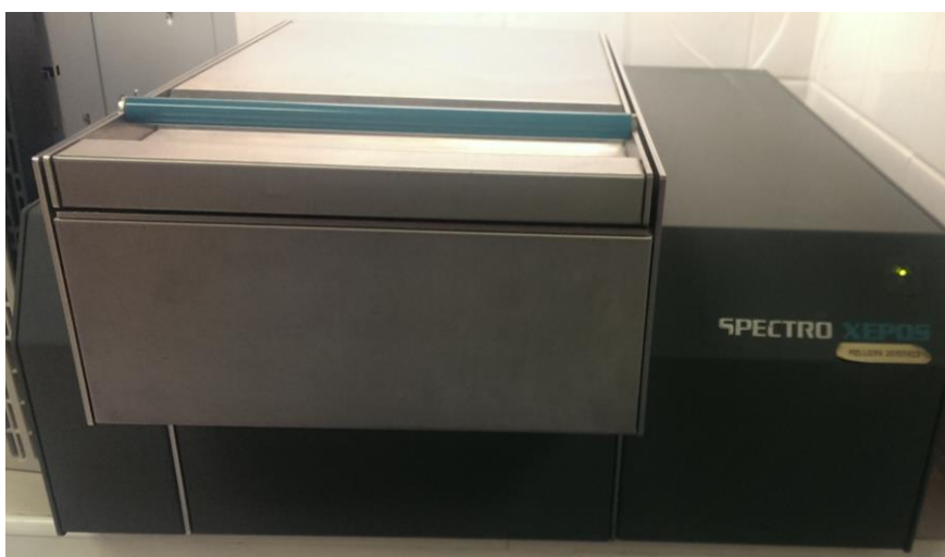
Obrázek 7.: Přístroj využívaný pro metodu rentgenové difrakční spektrometrie – Spectro xepos (Spectro CS, Česká republika).
