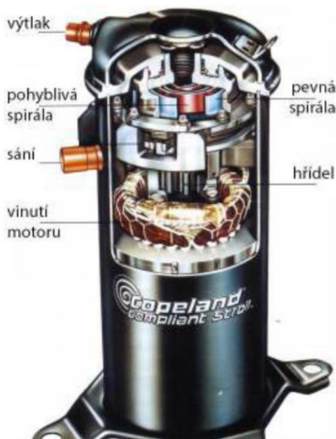
Obr. 3.5 Scroll kompresor [20]
