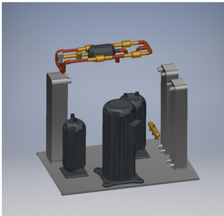
Obr. 5.21 Návrh rozmístění komponent chladičového oběhu TČ
