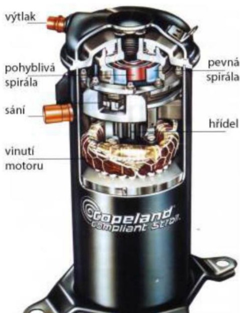
Obr. 3.5 Scroll kompresor [20]
