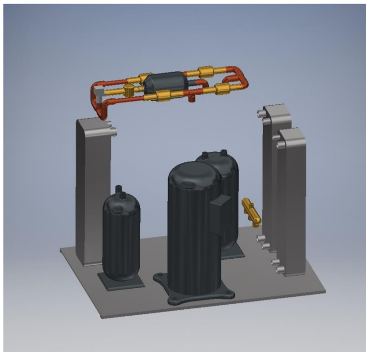
Obr. 5.21 Návrh rozmístění komponent chladičového oběhu TČ
