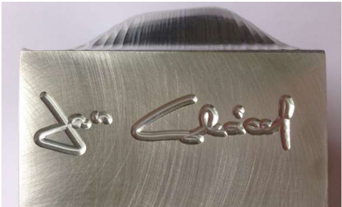
Obr. 3.7 Obrobek s vyfrézovanou konturou podpisu.
