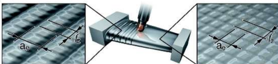
Obr. 4.1 Pro semi-roughing (vlevo) se používá f_z \ll a_e . Pro dokončovací operaci (finishing) f_z \approx a_e [23].
