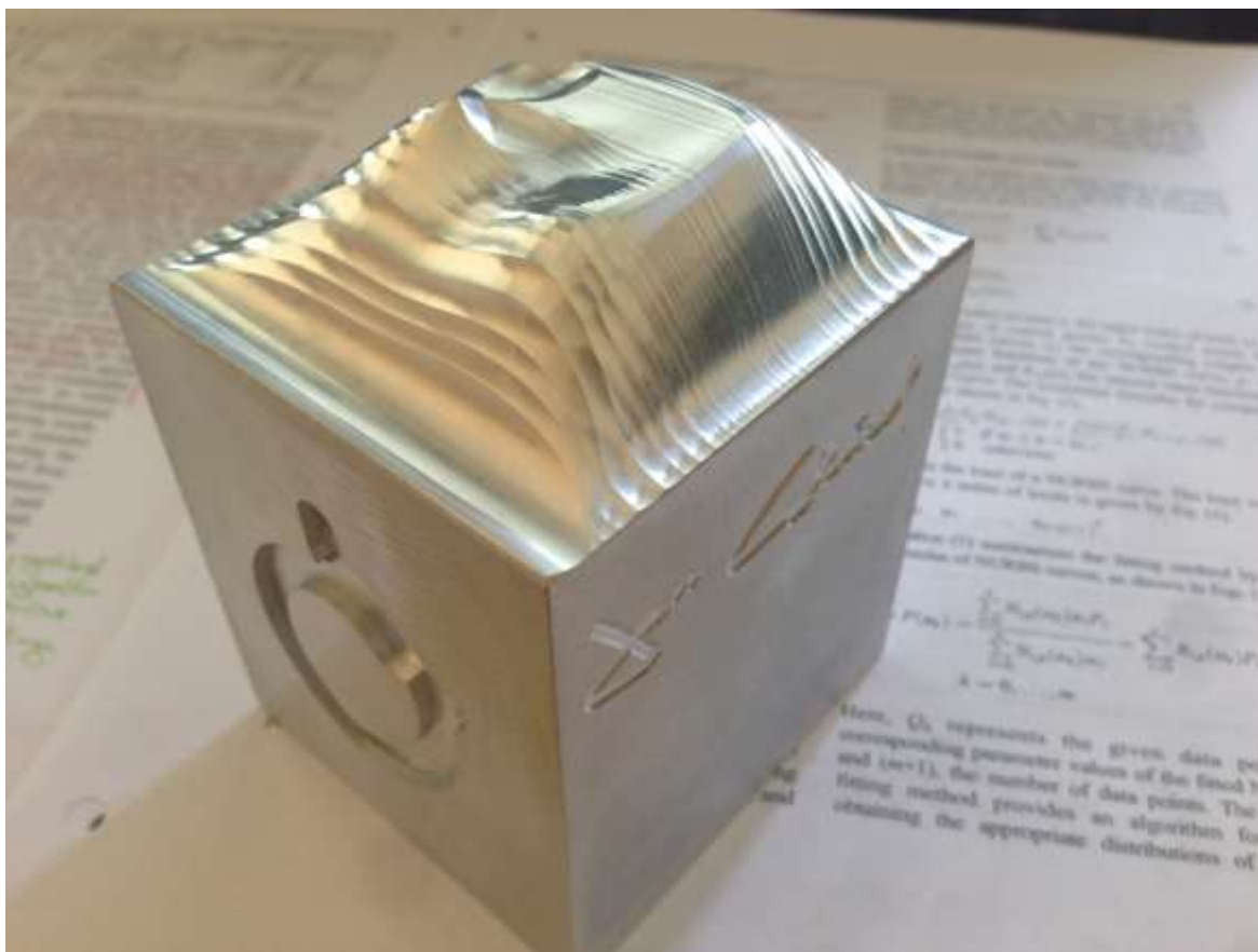
Obr. 3.16 Kompletní obrobek se zaměřením na 3D plochu. Na fotografii jsou dobře patrné vruby mezi hrubými průřezky.
