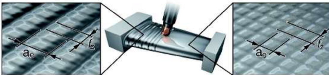
Obr. 4.1 Pro semi-roughing (vlevo) se používá f_z \ll a_e . Pro dokončovací operaci (finishing) f_z \approx a_e [23].
