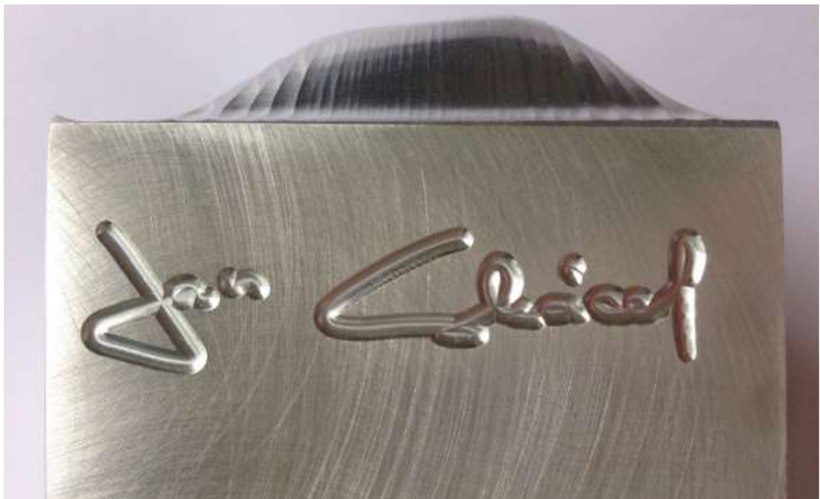
Obr. 3.7 Obrobek s vyfrézovanou konturou podpisu.
