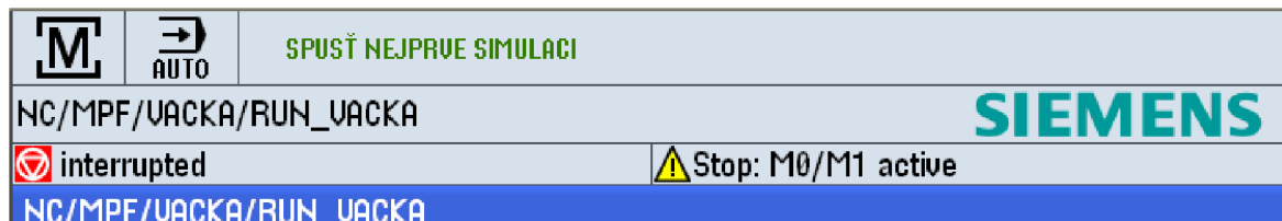
Obr. 3.19 Přerušení, pokud operátor zadal příkaz EXECUTE pro odeslání programu do zpracování a nebyla simulací vytvořena geometrie.
