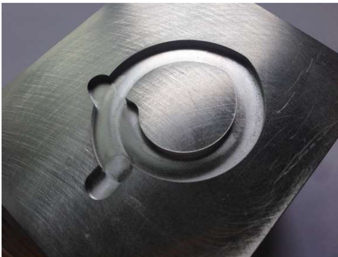
Obr. 3.21 Kontura vačky, v levé části náběh a výběh z kontury, v pravé horní části viditelný přechod z kruhové interpolace nahoře a spirály vpravo a dole.
