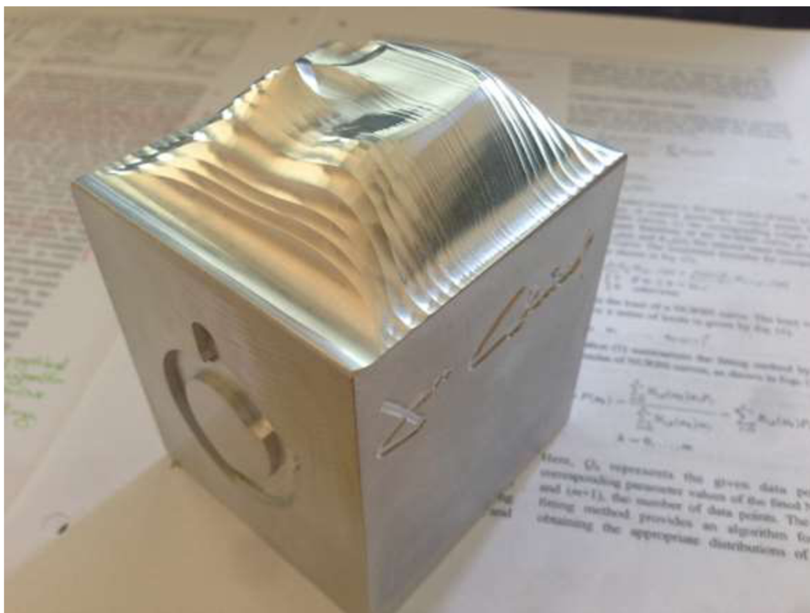
Obr. 3.16 Kompletní obrobek se zaměřením na 3D plochu. Na fotografii jsou dobře patrné vruby mezi hrubými průřezy.
