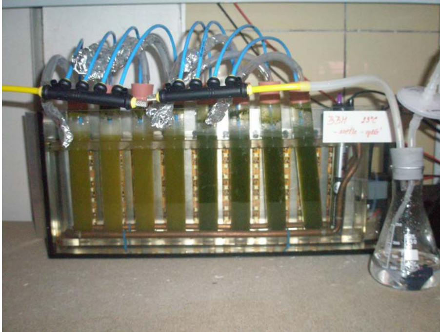
3. Kultivační zařízení – vyšší světla: kultivační akvárium s osmi 100 ml válečky se vzduchováním, panel diodových světél je umístěn za kultivačním akváriem, k docílení různé intenzity světél je pootočeno (zešíkmeno) kultivační akvárium vůči panelu světél, pravá strana je blíže světélům.
