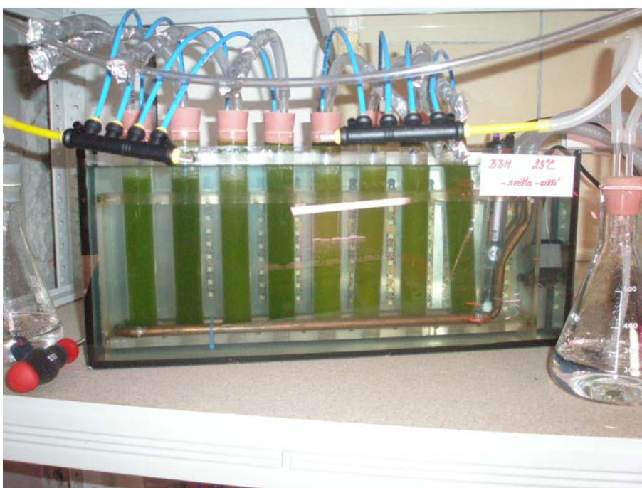
2. Kultivační zařízení – nižší světla: kultivační akvárium s osmi 100 ml válečky se vzduchováním, panel diodových světel je umístěn za kultivačním akváriem, k docílení různé intenzity světla je pootočeno (zešíkmeno) kultivační akvárium vůči panelu světel, pravá strana je blíže světlům.
