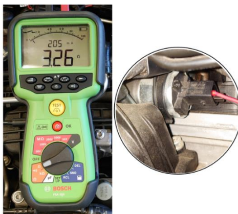
Obrázek 3.15: Hodnota odporu ventilu
