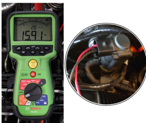
Obrázek 3.19: Hodnota odporu ventilu
