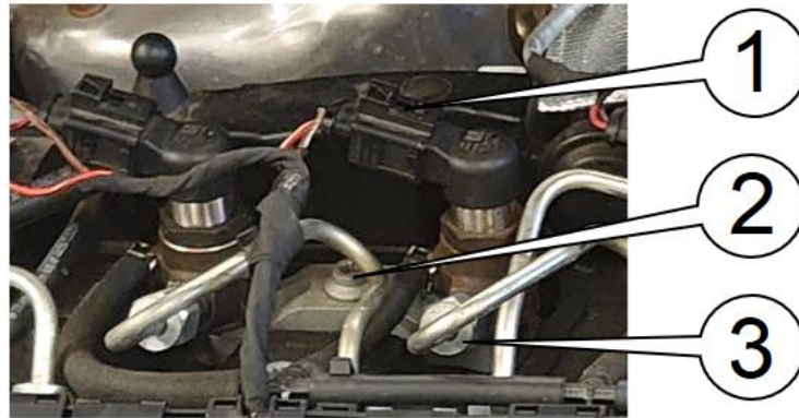
Obrázek 3.7: Demontáž piezoelektrického vstřikovače
