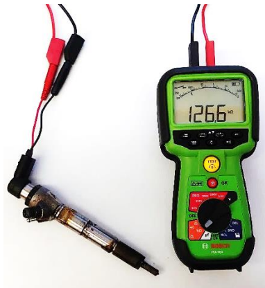
Obrázek 3.10: Zkouška vybíjecího odporu piezo modulu
