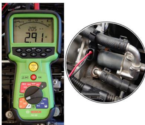
Obrázek 3.17: Hodnota odporu ventilu
