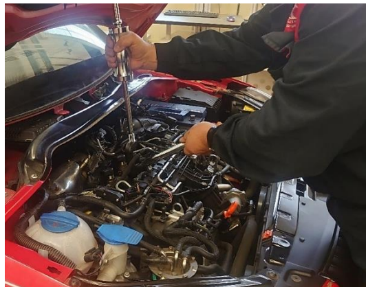
Obrázek 3.8: Demontáž piezoelektrického vstřikovače
