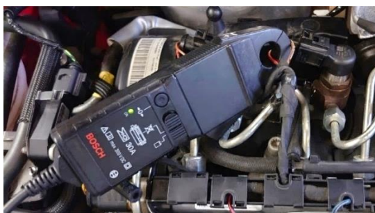
Obrázek 3.5: Připojení proudových kleští na piezoelektrický vstřikovač
