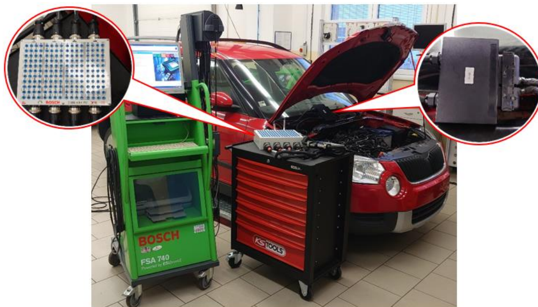
Obrázek 3.3: Připojení systémového zkušebního adaptéru k ŘJM
