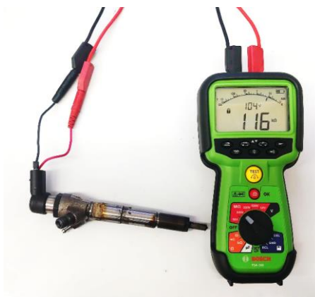
Obrázek 3.11: Zkouška piezo modulu na poškození
