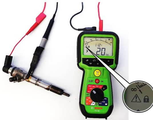
Obrázek 3.9: Zkouška izolace piezoelektrického vstřikovače
