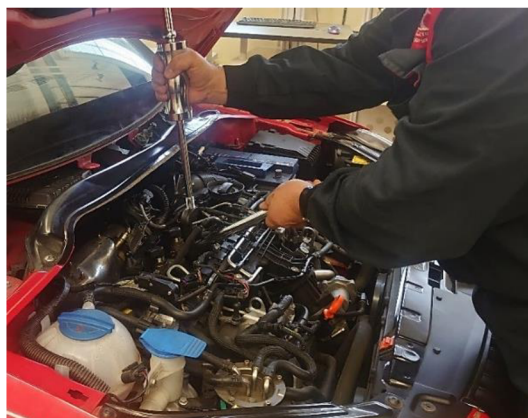
Obrázek 3.8: Demontáž piezoelektrického vstřikovače
