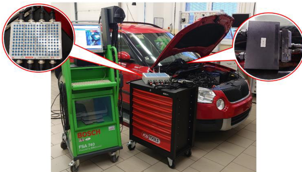
Obrázek 3.3: Připojení systémového zkušebního adaptéru k ŘJM
