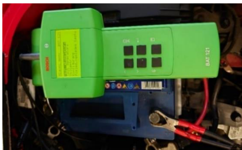
Obrázek 3.1: Zapojení Bosch BAT 121
