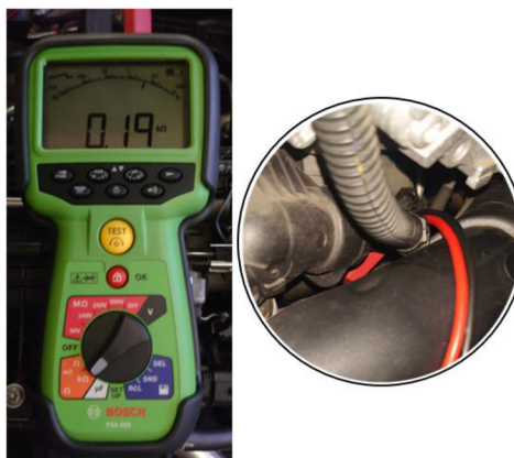
Obrázek 3.30: Odpor snímače teploty chladicí kapaliny
