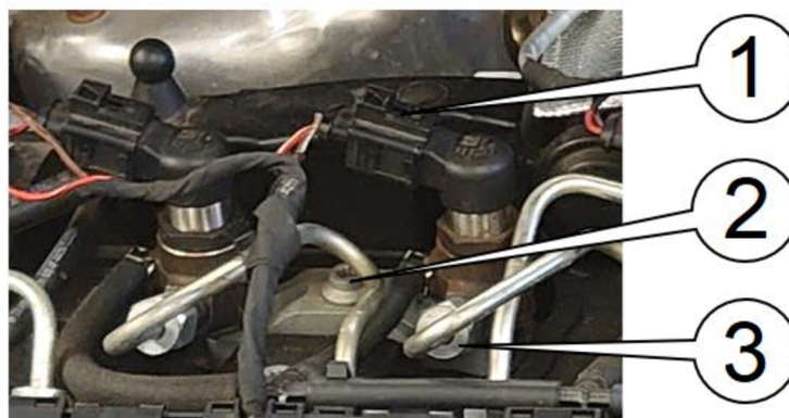
Obrázek 3.7: Demontáž piezoelektrického vstřikovače
