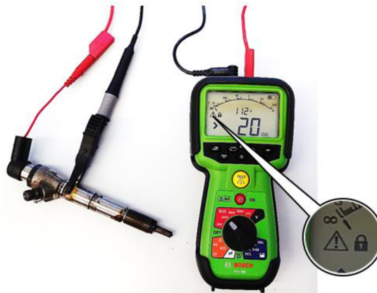
Obrázek 3.9: Zkouška izolace piezoelektrického vstřikovače
