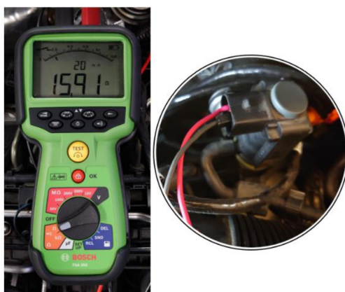
Obrázek 3.19: Hodnota odporu ventilu
