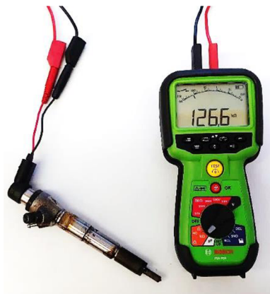
Obrázek 3.10: Zkouška vybíjecího odporu piezo modulu
