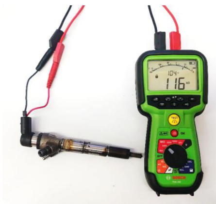
Obrázek 3.11: Zkouška piezo modulu na poškození
