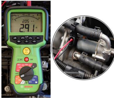
Obrázek 3.17: Hodnota odporu ventilu
