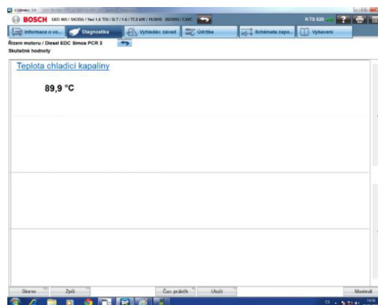
Obrázek 4.15: Skutečná hodnota snímače teploty chladicí kapaliny (SW: ESI [tronic] 2.0)
