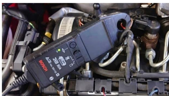
Obrázek 3.5: Připojení proudových kleští na piezoelektrický vstřikovač
