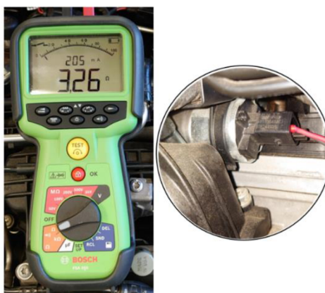
Obrázek 3.15: Hodnota odporu ventilu
