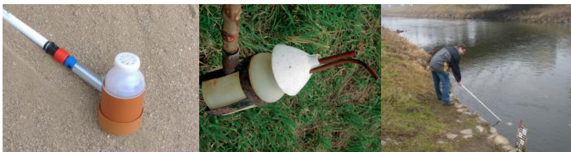
Obr. 2. Ruční vzorkování: vlevo láhev s uzávěrem s otvory, uprostřed láhev s odvzdušňovací trubicí, vpravo ukázka ručního vzorkování [4][5]
