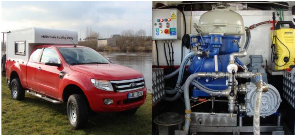
Obr. 6. Mobilní odstředivka: vlevo automobil s nainstalovanou odstředivkou, vpravo nainstalovaná odstředivka [5]
