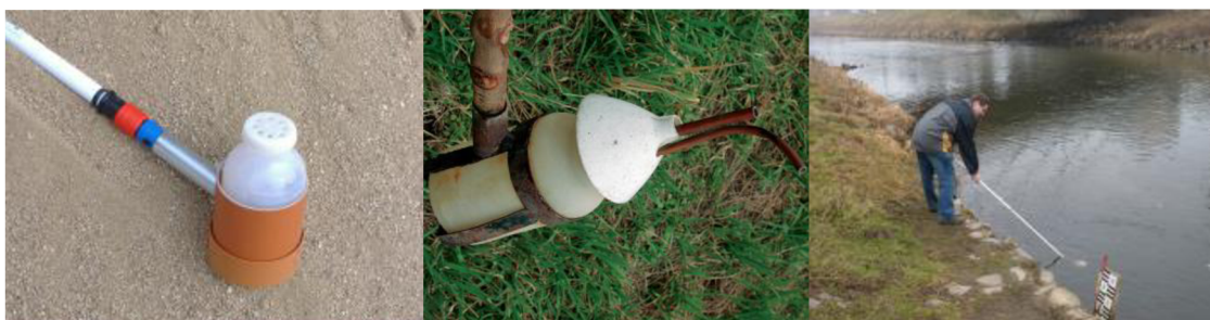
Obr. 2. Ruční vzorkování: vlevo láhev s uzávěrem s otvory, uprostřed láhev s odvzdušňovací trubicí, vpravo ukázka ručního vzorkování [4][5]
