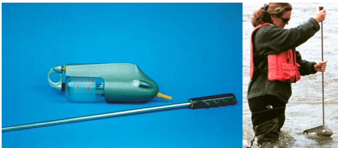
Obr. 11. Vzorkovač US DH-48 (vlevo), ukázka správného postoje při odebrání vzorků zařízením US DH-48 (vpravo) [11]
