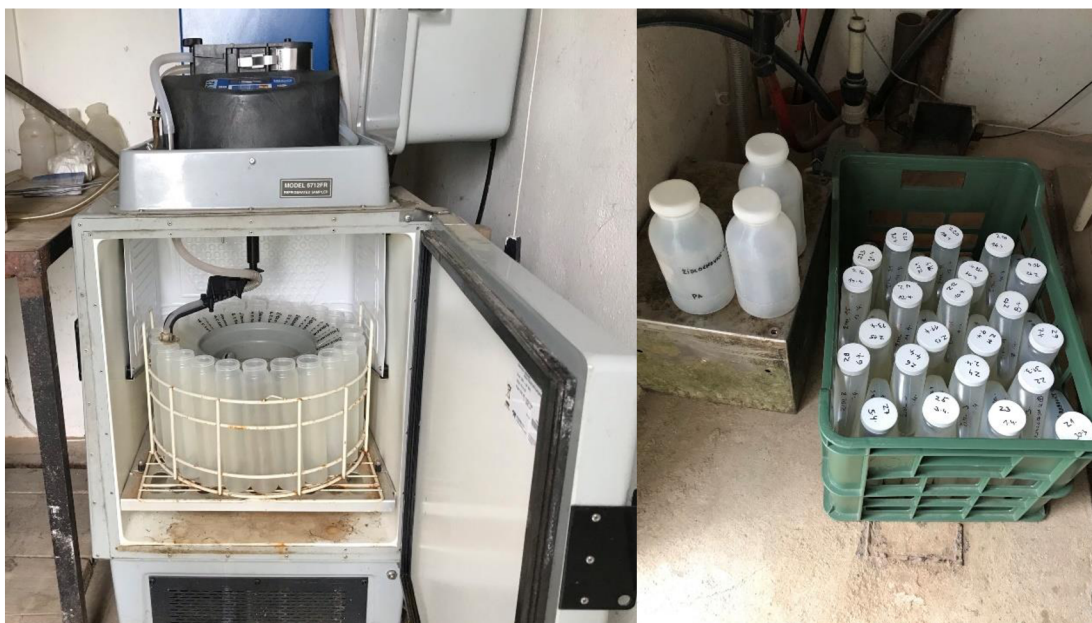
Obr. 4. Sampler 6712-FR v Židlochovicích (vlevo), samplerem odebrané vzorky (vpravo)
