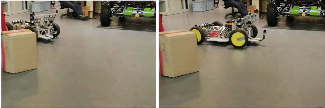
(a) Vozidlo se úspěšně vyhne překážce (b) Osoba se dostane mimo zorné pole UWB systému
