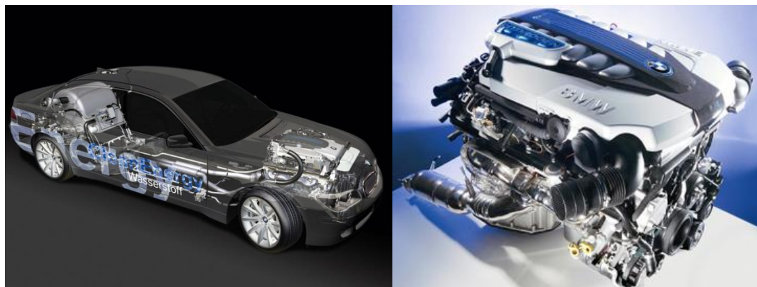
Obrázek 19 BMW Hydrogen 7 a upravený motor V12 [56]
