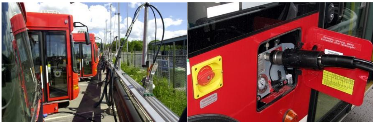
Obrázek 21 Stání autobusů Volvo s plněním bioplynu [29]
