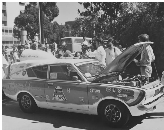
Obrázek 17 Musashi 1 Datsun: Nissan Sunny poháněný zkapalněným vodíkem [55]
