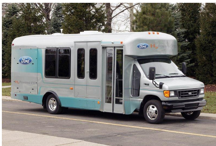
Obrázek 20 Mikrobus Ford E450 na vodík [47]
