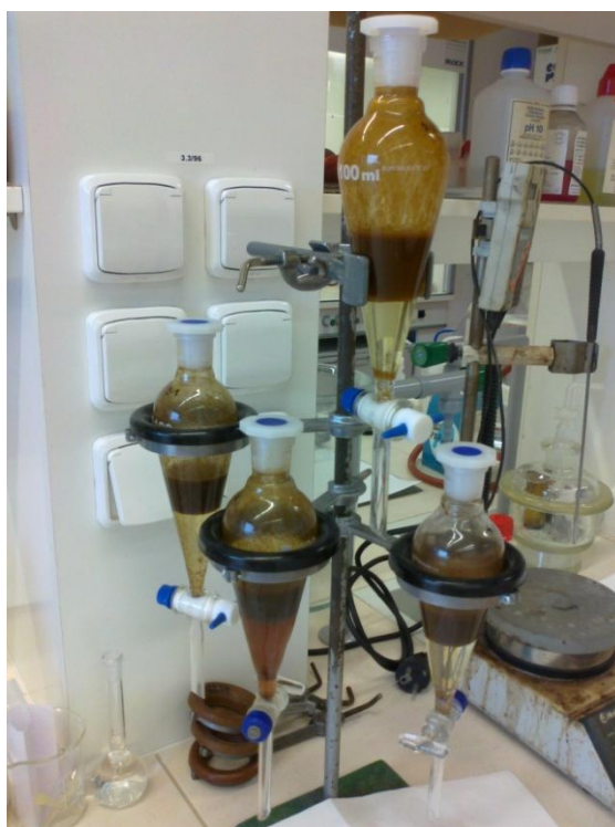
Obrázek 8: Fázový přenos nanočástic z vodné fáze do organického rozpouštědla za využití přenosového činidla a stabilizátoru
