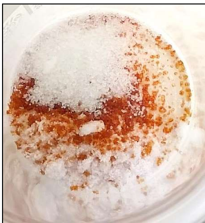
Obrázek 48 Směs nonahydrátu dusičnanu železitého s glycinem
