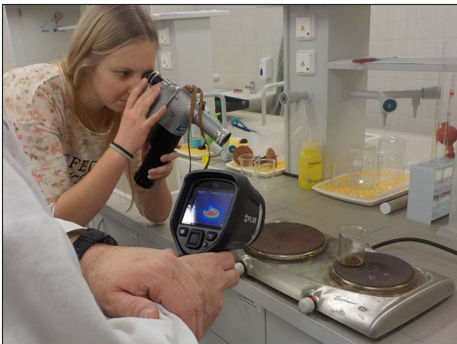
Obrázek 36 Měření teploty optickým pyrometrem a termokamerou
