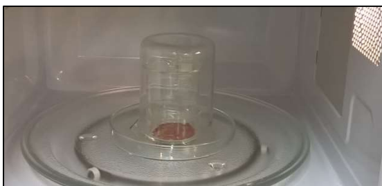
Obrázek 41 Ohřev pomocí mikrovlnné trouby – počátek reakce
