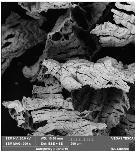
Příloha 8 Produkt reakce s urotropinem – fotografie ze SEM při zvětšení 200x
