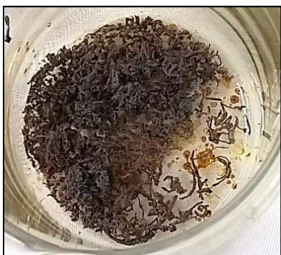
Obrázek 43 Produkt reakce při ohřevu v mikrovlnné troubě
