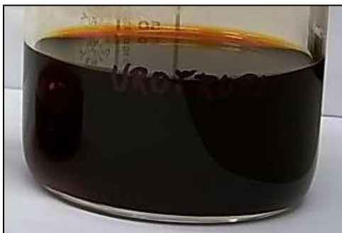
Obrázek 25 Roztok nonahydrátu dusičnanu železitého s urotropinem
