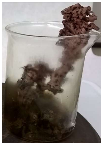
Obrázek 18 Produkt reakce směsi s nadbytkem paliva
