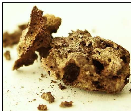
Obrázek 52 Produkt přímé reakce nonahydrátu dusičnanu železitého s glycinem
