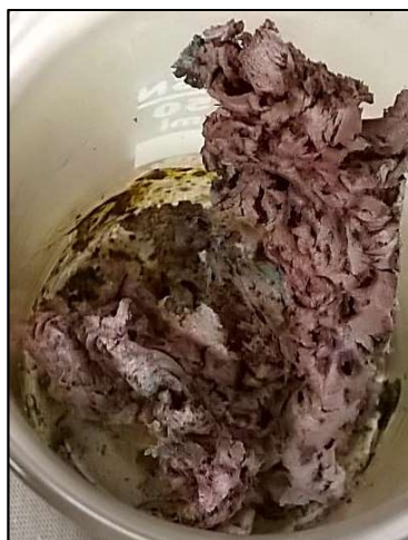
Obrázek 54 Výsledný produkt reakce s glycinem – nadbytek paliva
