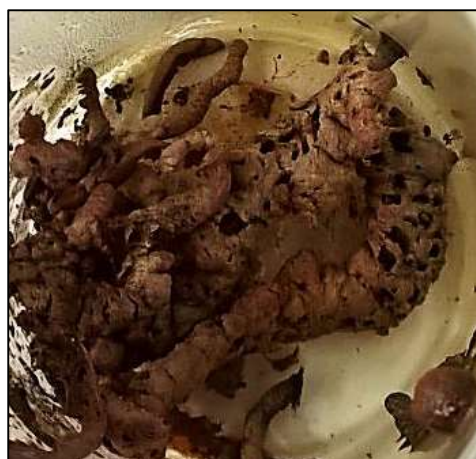
Obrázek 12 Produkt reakce směsi s nadbytkem paliva
