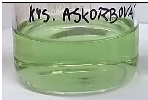
Obrázek 33 Roztok nonahydrátu dusičnanu železitého s kyselinou askorbovou
