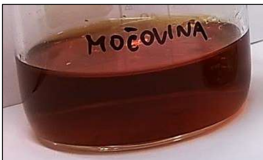
Obrázek 27 Roztok nonahydrátu dusičnanu železitého s močovinou
