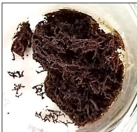
Obrázek 11 Produkt reakce směsi s molárním poměrem hodnoty 1
