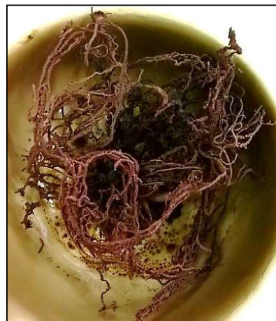
Obrázek 39 Výsledný produkt ohřevu zapálením acetonu
