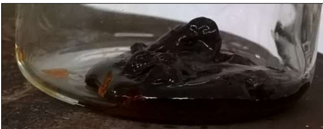
Obrázek 14 Roztékání směsi s nadbytkem paliva
