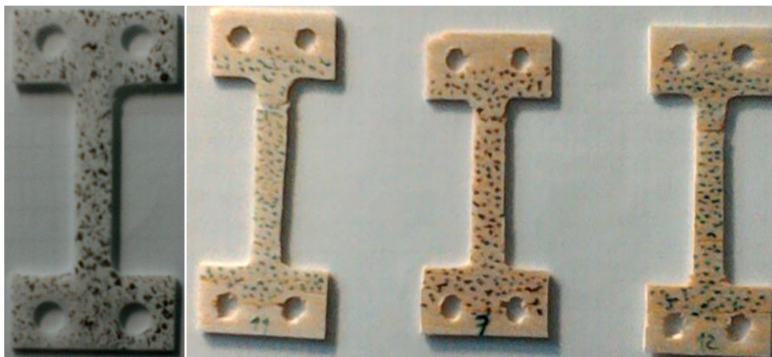
Obr. 15 Tělíska vlevo je plastový vzor pro výrobu zkušebních těles; ostatní jsou zkušební tělíska z balzy
