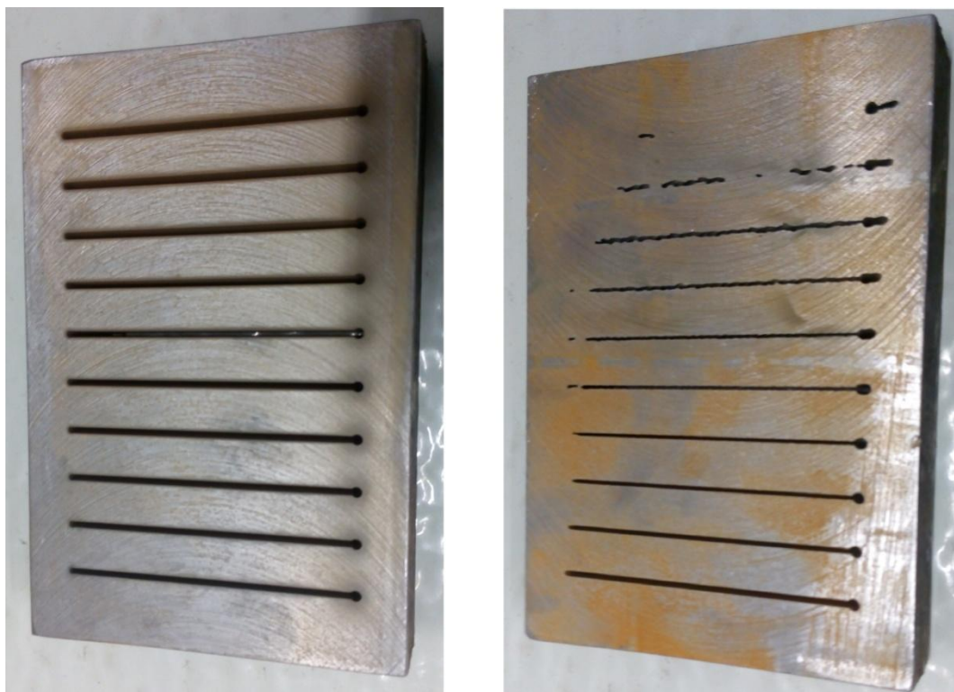
Obrázek 25 Ukázka řezných spár lícové a rubové strany zkoumaného vzorku a vliv řezné rychlosti
