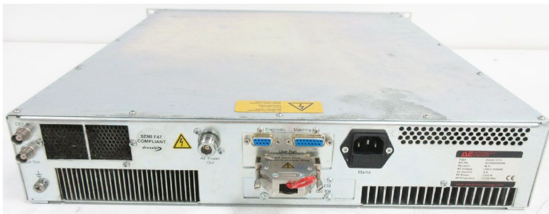
Obrázek 2.10: RF generátor Cesar 1312 konektory (zdroj: [7])
