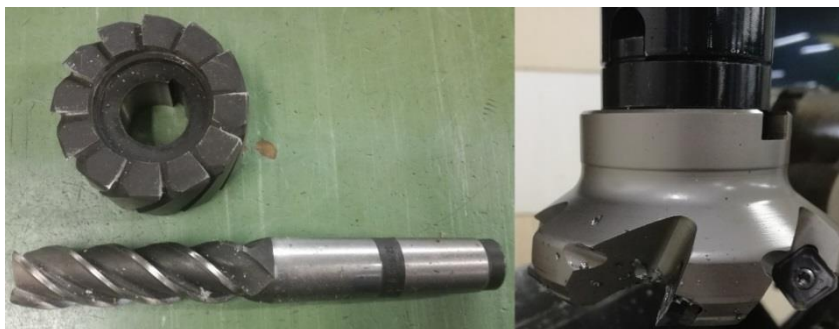
Obr. 10 Frézovací nástroje (vlevo monolitní, vpravo s VBD).
