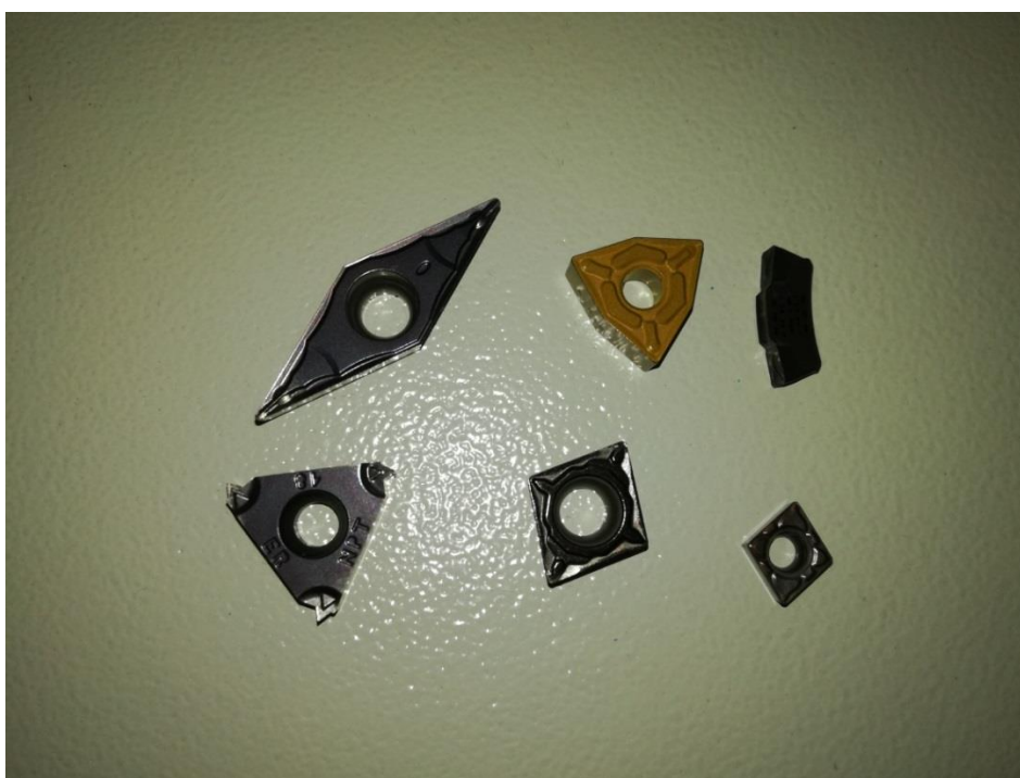
Obr. 5 Ukázka břitových destiček ze slinutého karbidu.
