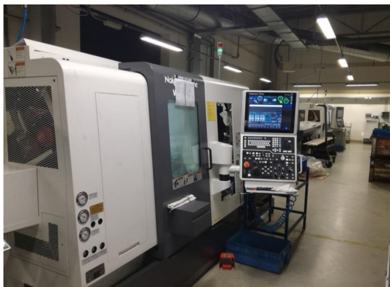
Obr. 1 Pohled na CNC soustruh Nakamura Tome WT100.
