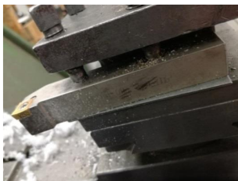
Obr. 7 Soustružnický nástroj s vyměnitelnou břitovou destičkou (upnutý v nožové hlavě).
