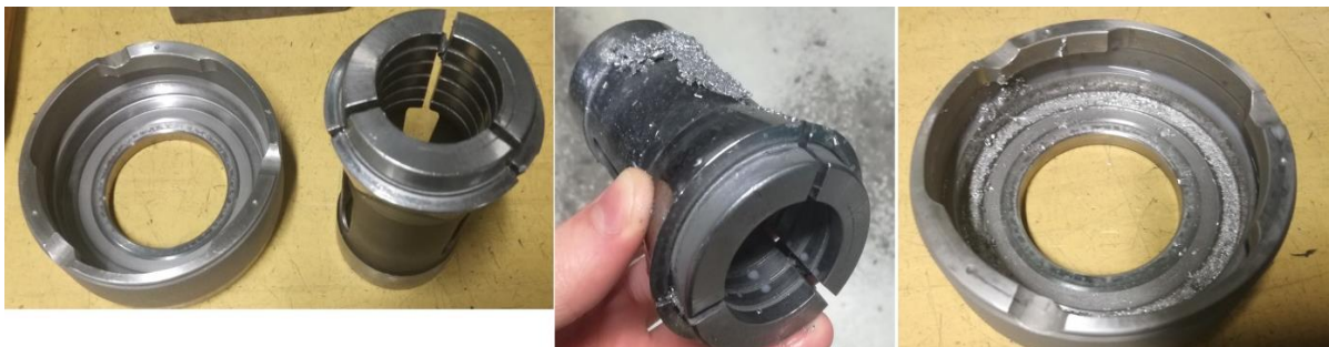
Obr. 30 Ukázka zanešení kleštiny nečistotami.
