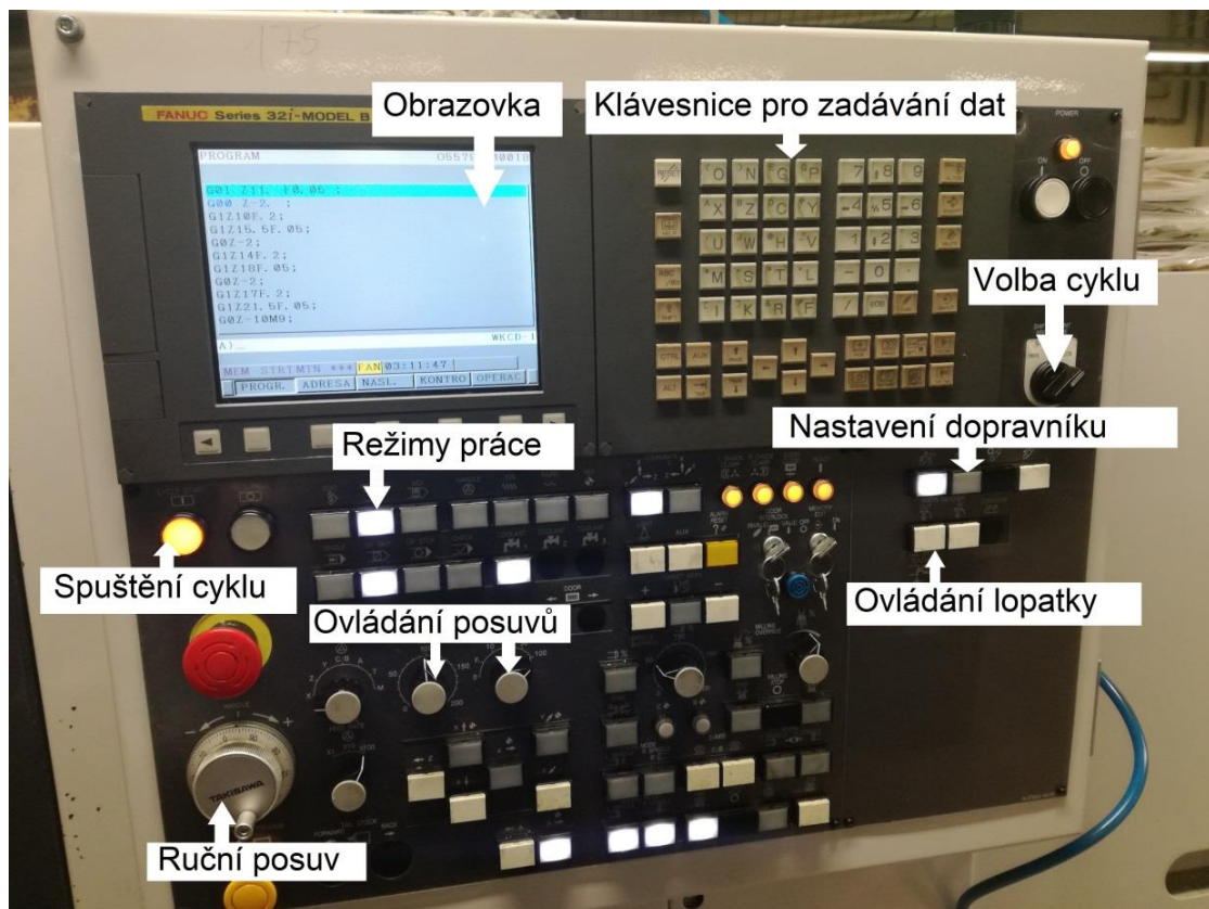
Obr. 12 Ovládací panel CNC soustruhu Takisawa.
