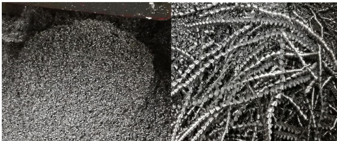
Obr. 4 Ukázka dvou odlišných typů třísek (elementární a vinuté).
