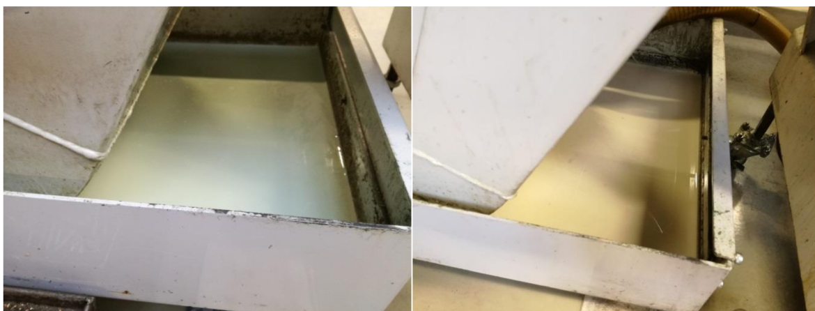
Obr. 32 Ukázka zbarvení totožné procesní kapaliny v nádržích CNC soustruhů.
