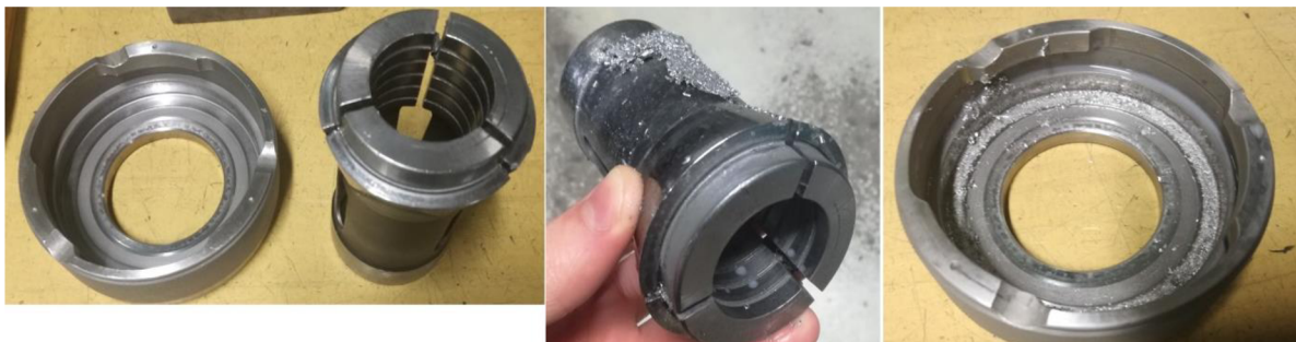
Obr. 30 Ukázka zanešení kleštiny nečistotami.
