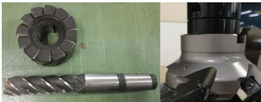
Obr. 10 Frézovací nástroje (vlevo monolitní, vpravo s VBD).
