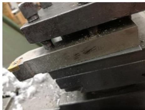
Obr. 7 Soustružnický nástroj s vyměnitelnou břitovou destičkou (upnutý v nožové hlavě).
