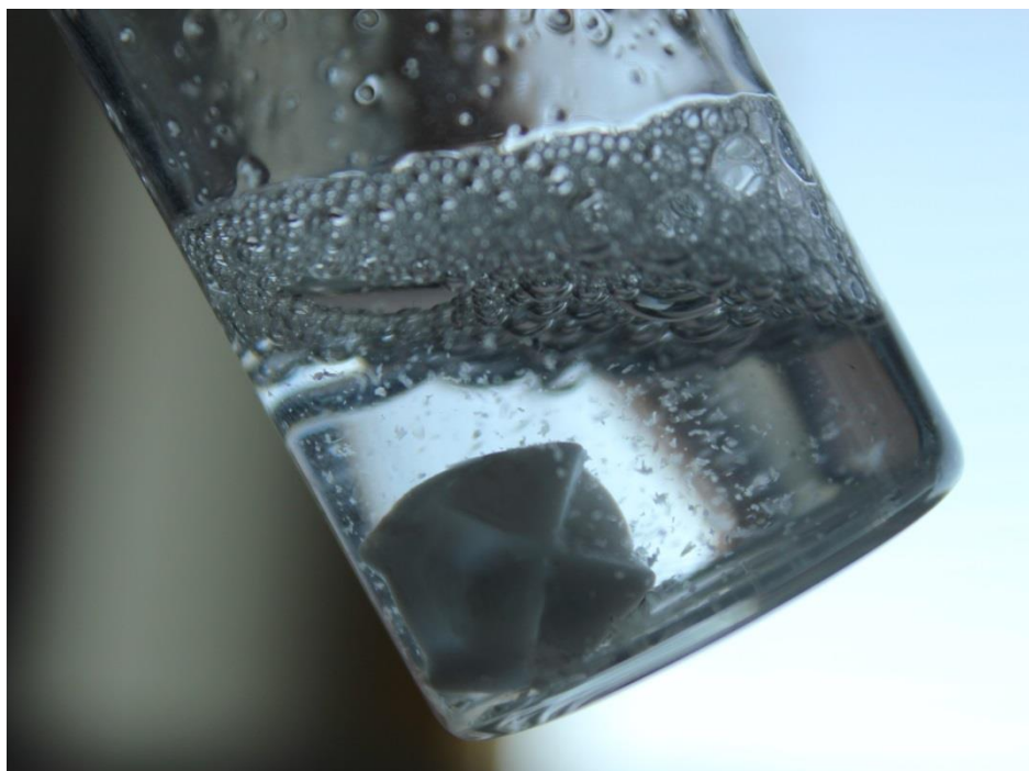
Obr. 24: Vzniklé sraženiny při titraci CTAB (50 mM) do hyaluronanu ( c = 1 \text{ g}\cdot\text{dm}^{-3} ).
