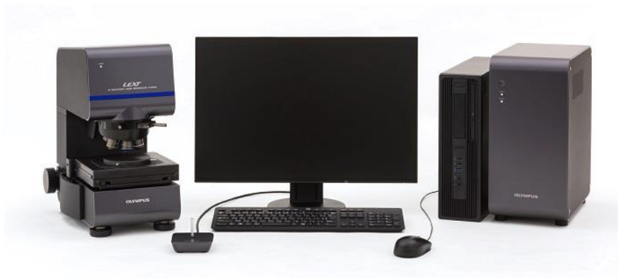
Obrázek 20: Konfokální mikroskop LEXT OLS 5000. Převzato z [28][28].
