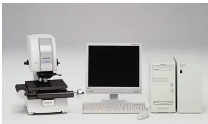
Obrázek 19: Konfokální mikroskop LEXT OLS 3100. Převzato z [26].
