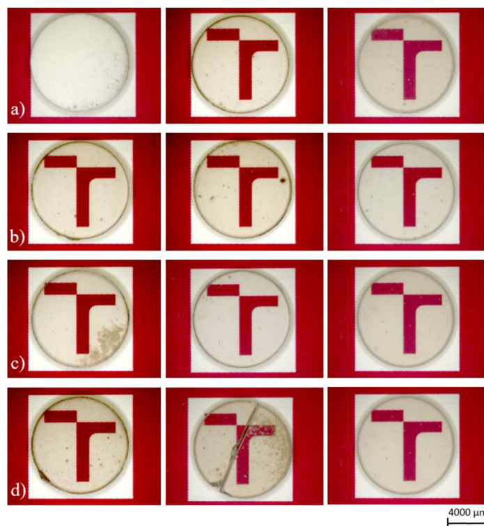
Obr. 27 Porovnání vzorků po HIP předslinutých při 1490, 1500 a 1510 °C, a) 0,01 at. % Cr 3+ , b) 0,02 at. % Cr 3+ , c) 0,03 at. % Cr 3+ d) 0,04 at. % Cr 3+
