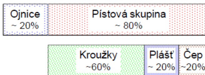
Obr. 2.5: Vliv jednotlivých komponent na ztráty v pístové skupině [7]
