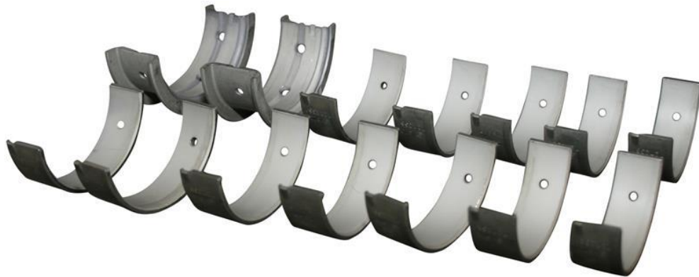
Obr. 2.9: Dělená ložiska klikového hřídele (Porsche 911) [13]
