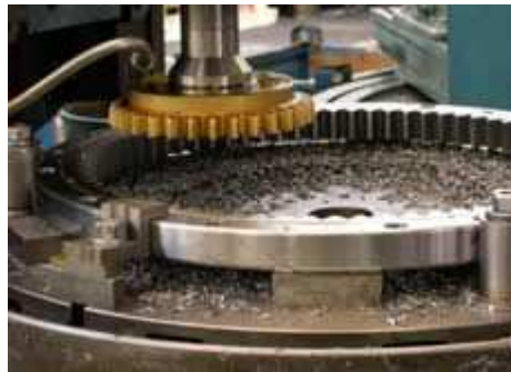
Obr.1.7 Obrázení vnitřního ozubení kotoučovým nožem [8]
