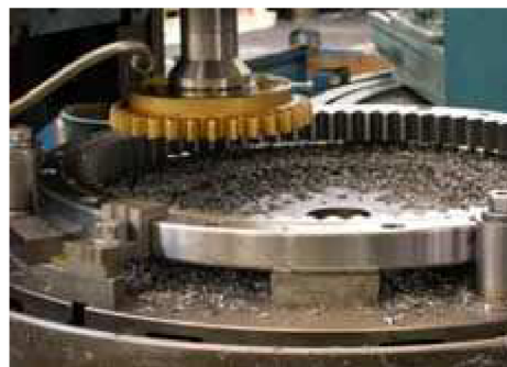
Obr.1.7 Obrázení vnitřního ozubení kotoučovým nožem [8]
