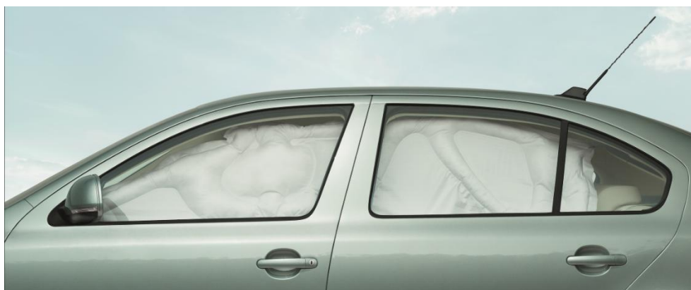
Obr. 16 Aktivovaný hlavový airbag ve vozidle Škoda Octavia II, vnitřní a vnější pohled [2]
