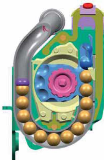
Obr. 28 Soustava kuliček, které otáčejí ozubeným kolem předepínače pásů [1]
