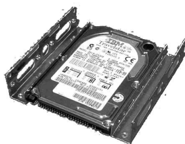
Obr. 3.8: Možné uchycení HDD v DC [34]
