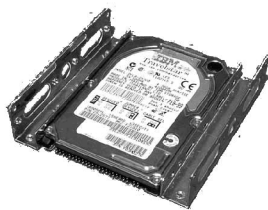
Obr. 3.8: Možné uchycení HDD v DC [34]
