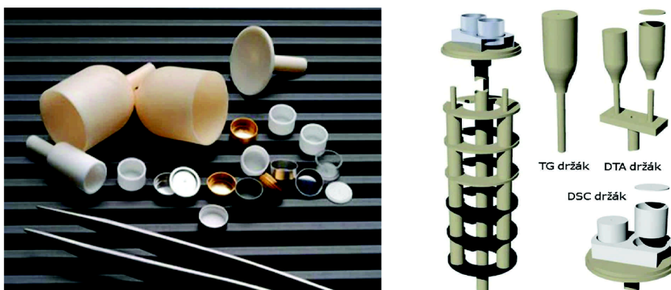
Obrázek 2.3: Vlevo: Běžné typy nosičů vzorků pro TG a DSC. Převzato a upraveno z [10]; Vpravo: Konstrukce držáků vzorků. Převzato a upraveno z [24].
